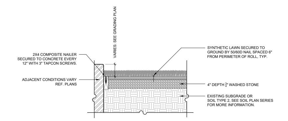
PAVING, TYPE 4 (ARTIFICIAL TURF)
